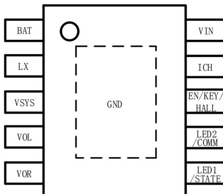
Fig.5. 芯片引脚示意图
